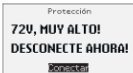
Figura 4.1 Advertencia de tensión excesiva
