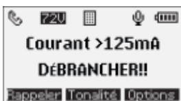
Illustration 4.2 Avertissement de surintensité
